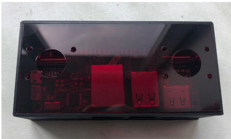
شکل ۱۴: برد مرکزی و محفظه آن در سیستم طراحی شده برای تشخیص بیماری هتروکرومیا
