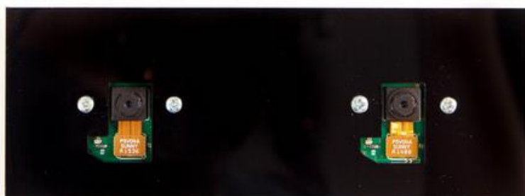
شکل ۱۵: دوربین های سیستم طراحی شده برای تشخیص بیماری هتروکرومیا
